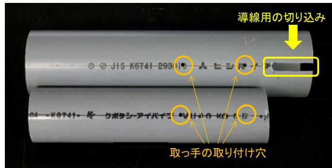
図 11. 塩ビ薄肉管の加工. 50A×25 cm(上), 40A×20 cm(下)
