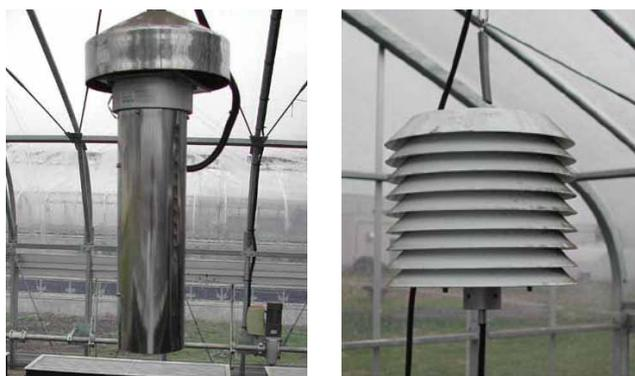
図2. 強制通風式の放射よけ(左)と自然通気式の放射よけ(右)
