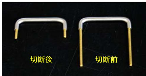
図 9. 取っ手のネジを 10 mm に切断
