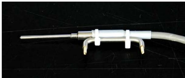
図 10. センサーを取っ手に固定
