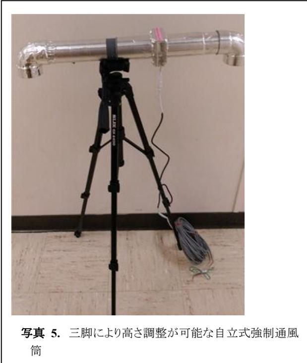
写真 5. 三脚により高さ調整が可能な自立式強制通風筒
