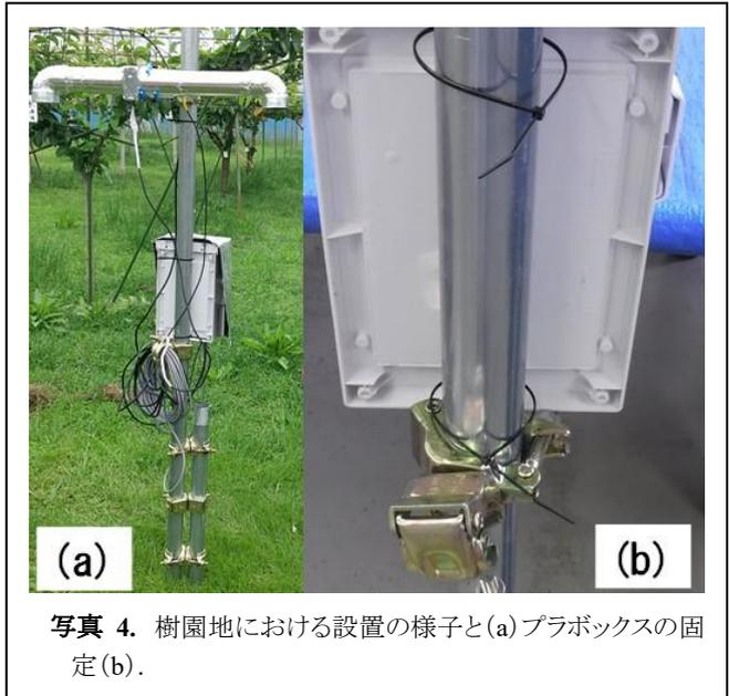
写真 4. 樹園地における設置の様子と(a)プラボックスの固定(b).
