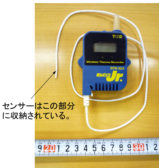
図5. サーミスタ温度センサーの例 (T & D, RTR-52A)。
