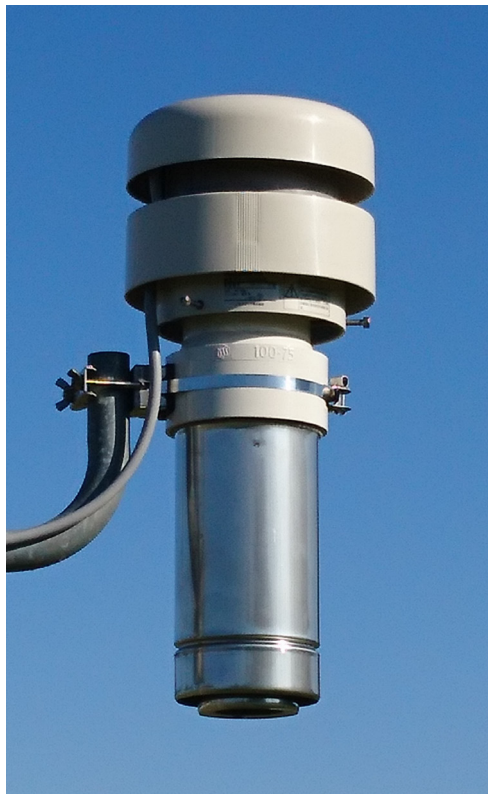
図 1. NIAES-09S 改型強制通風筒の外観と構造（断面図）
