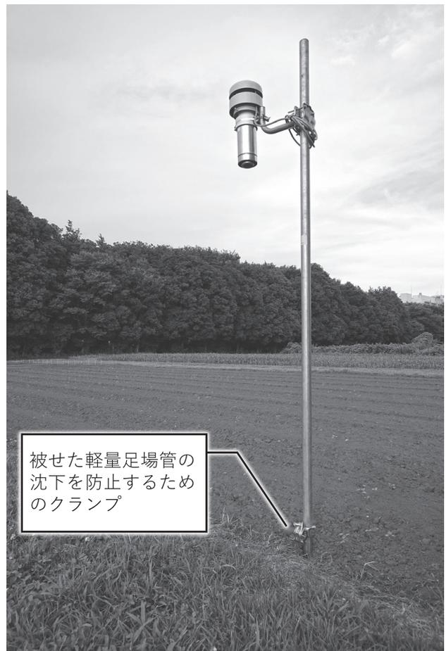
図14. 鋼管杭に軽量足場管を被せて使う簡易な観測用マスト。
