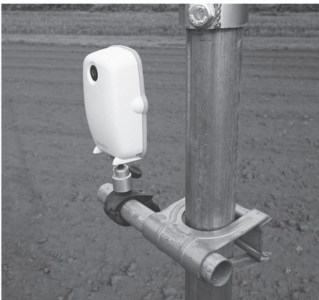
図12. ハウスパイプと金具を使ってマストにカメラを取り付けた様子。
