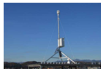
ブリード 太陽電池式ウェザーステーション 各種データロガー 各種センサー 対応可能。
